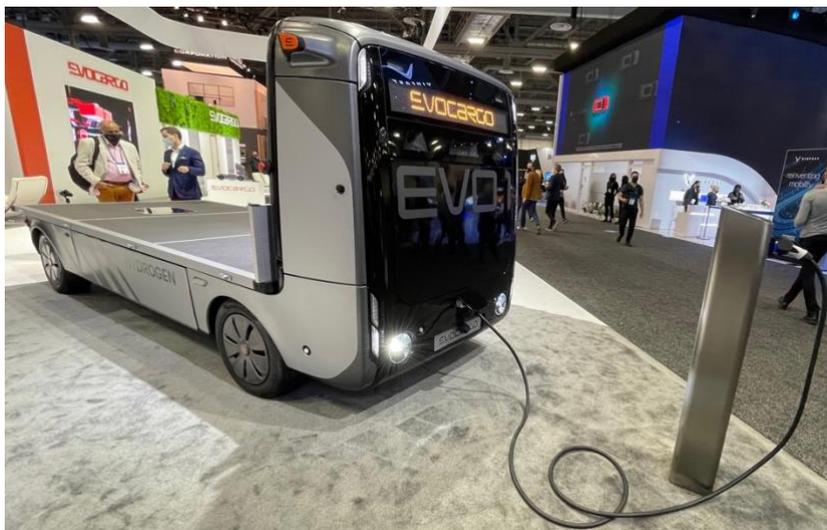
Dans un autre genre, Svocargo a créé une plateforme autonome dédié au transport au sein des usines. Une plateforme guidée par le sol et alimentée à l'hydrogène.
