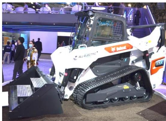
Tirant parti de la version électrique de ces engins bien connus, Bobcat mettra en avant l'absence de vibration et de bruit qui, généralement, caractérise ce type d'engins.
