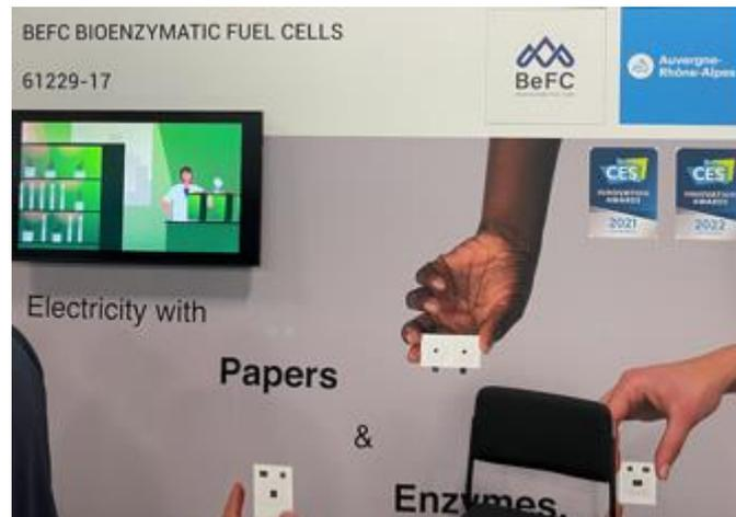
Son utilisation sur des objets connectés peu gourmands, comme ceux qui utilisent des réseaux LoRa ou Sigfox, semble tout à fait adaptée. La pile est flexible et plate donc facile à utiliser dans un circuit. Elle ne contient pas de métal et est donc facile à recycler.
