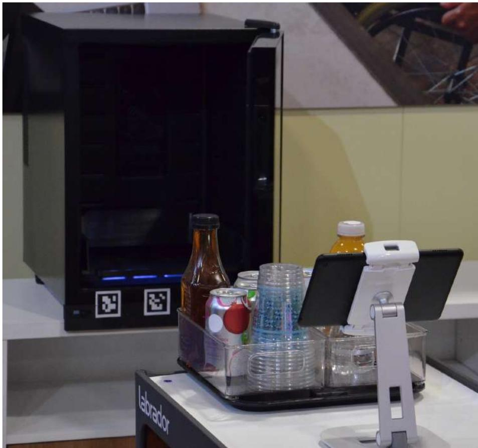
Un robot qui porte des charges jusqu'à 11 kg et est capable de commander un réfrigérateur pour les placer de manière autonome.
