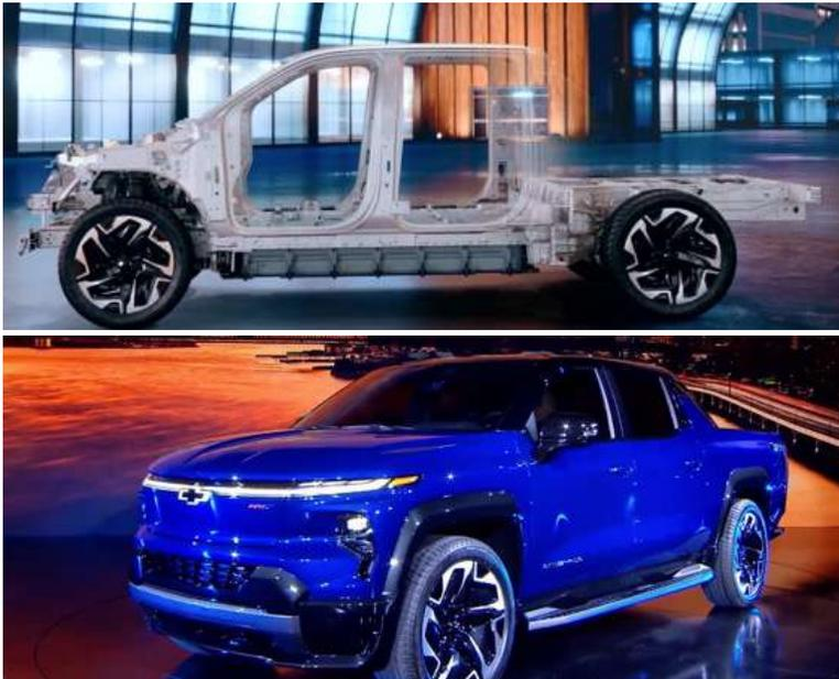
L'EV Silverado se base sur la technologie Ultium (batteries et plateforme modulaire)
