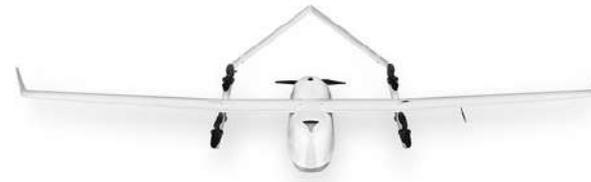
DJ25 - Fuel cell powered VTOL, fonctionnement à l'hydrogène
