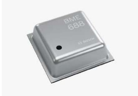
Un des premiers capteurs de gaz doté d'une intelligence artificielle et de capteurs de pression, d'humidité et de température intégrés.
