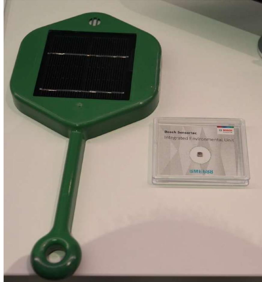
Ce capteur peut être utilisé pour détecter des denrées alimentaires périmées ou, comme ici, avec la solution Silvanet (Dryad Network) détecter par avance les feux de forêts.
