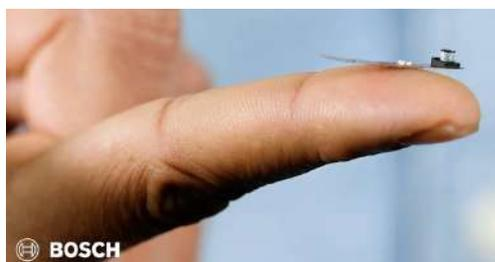
Aujourd'hui, il est désormais possible de **connaître exactement la composition de l'air que nous respirons, grâce au capteur bmv080** développé par Bosch. 450 fois plus petit que les autres capteurs équivalents, il peut s'insérer dans n'importe quel appareil électronique ou produit et offre donc **des possibilités de nouveaux usages et applications**.
