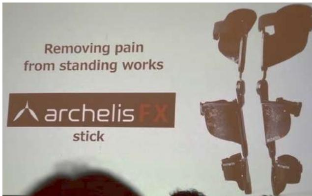
Cet exosquelette se veut simple à mettre en place. Une fois les sangles attachées, l'exosquelette fait bien ce pourquoi il a été conçu : pouvoir s'asseoir à tout moment lorsque l'on en a besoin dans le contexte d'une situation de travail en position debout prolongée.
