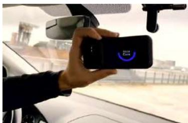
Ride Care Companion, un **dispositif avec des caméras à intégrer dans sa voiture**, qui permet via une simple pression ou son smartphone **d'alerter et d'échanger avec un opérateur** à distance, qui peut voir l'intérieur de l'habitacle.
