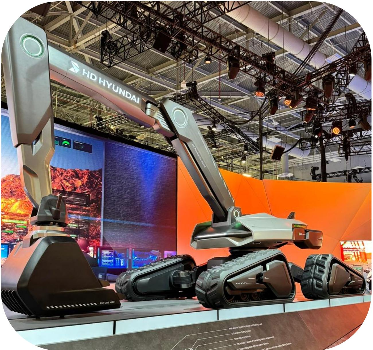
Franchement design, silencieuse, qui ne s'arrête que pour se recharger, et équipée de capteurs de détection et de sécurité, cette pelleuse électrique est présentée comme une réponse soutenable aux enjeux des entreprises minières et de construction.
